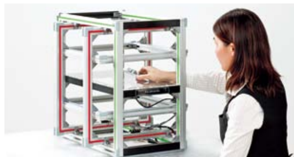
3組のコイルを組み合わせることで、任意の磁力を発生。様々な磁界状況のシミュレーションを可能にしました。
